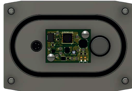
Abb. 3: CAD-Modell der Unterseite des oberen Deckelelements mit Sensorplatine (Mitte) und Lambdasonde (rechts).
