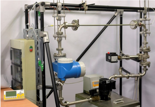
Bild 7 Prüfeinrichtung für Oberflächenthermometer zur Messung an gekrümmter Oberfläche
