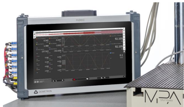
Bild 10 Für die Erprobung des dynamischen Kraft-Transfornormals verfügbares Messsystem des Typs PU[REC] der Fa. Dewetron
