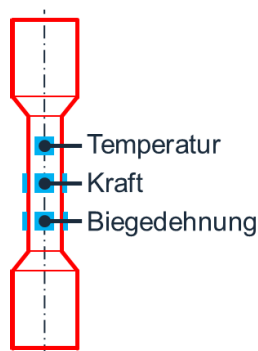
Bild 1 Schema einer in mehreren Ebenen mit DMS (blau) applizierten Standard-Rundzugprobe (rot)
