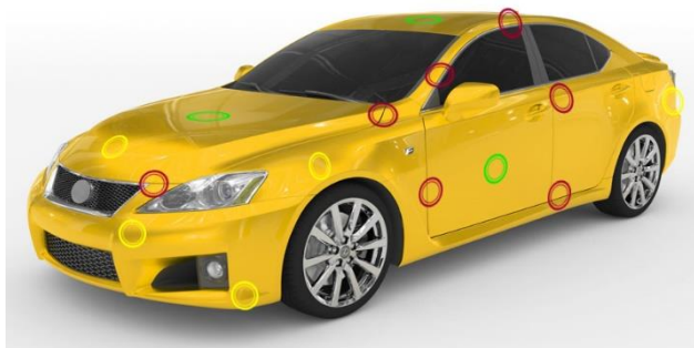
Bild 2 Kritische Beschichtungs- und Messbereiche
