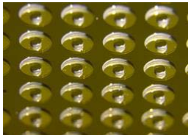
Abbildung 4: Tief geätzte Membranstrukturen auf der Waferrückseite nach dem Entfernen der Kupferätzmaske
