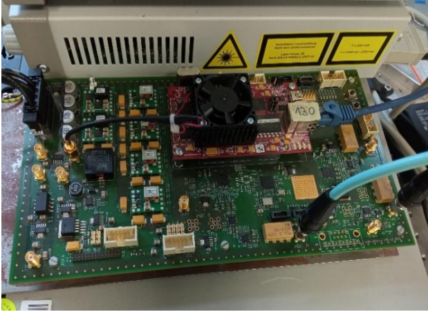
Bild 3 Digitale Schaltung als ein kostengünstiger und feldtauglicher Ersatz für einen VNA im digitalen I-OFDR-Verfahren.
