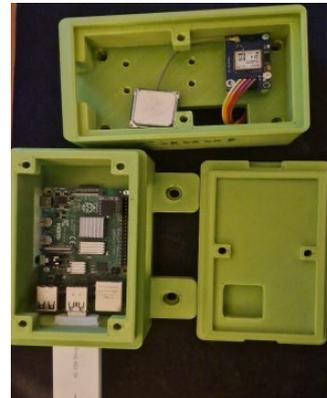
Abb. 2: Edge-Komponenten im Gehäuse [5]
