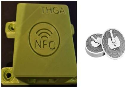
Abb. 3: NFC-Reader im Gehäuse u. Tags [5]
