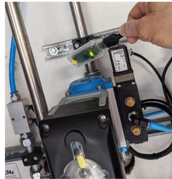
Abb. 15: Absuchen einer  $H_2$ -Versorgungsleitung und Ventilen mit dem Sensorsystem zum Auffinden von Leckagen.
