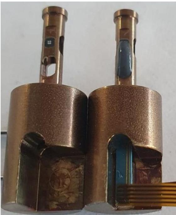
Abb. 12 Vollständiger Aufbau für die Innendruckmessung
