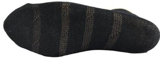
*Abb. 5: Druckmessstrumpf der dritten Generation mit eingestricktem Buskabel*
