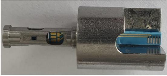
Abb. 10 Mechanischer Aufbau, Federkörper 1.4542, Si-DMS, Leiterplatte aus LTCC für den Anschluss des Si-DMS
