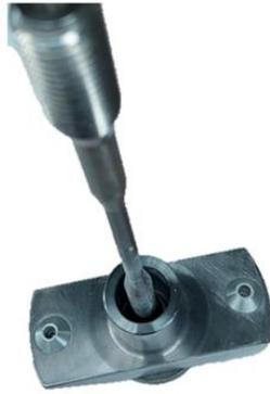
Abb. 3: Messprobe mit Ankerelement.
