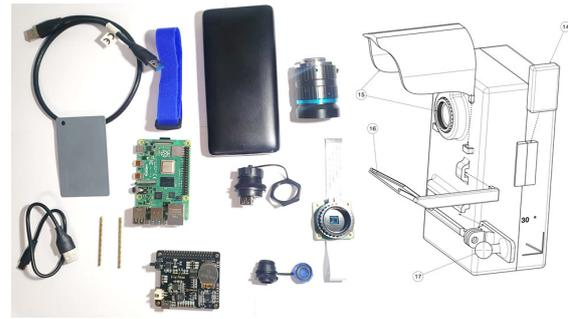
Abb. 5: 3D Gehäusemodell des EOW-RPI (rechts), Komponenten zur Erstellung des EOW-RPI Sensorsystems (links).
