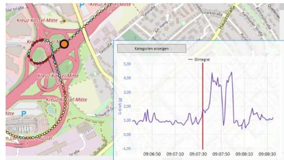
Abb. 5: Diagramm der g-Kräfte in der Umgebung eines Routenpunktes
