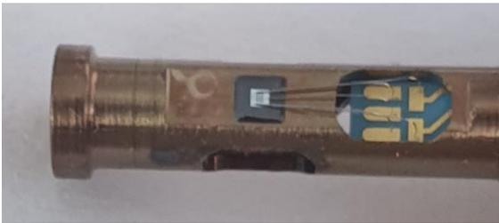
Abb. 11 Si-DMS gefügt mittels Glasfritte
