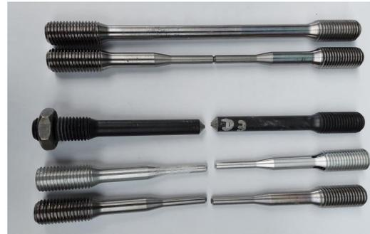
Abb. 5: Messprobe von Zugversuchen.
