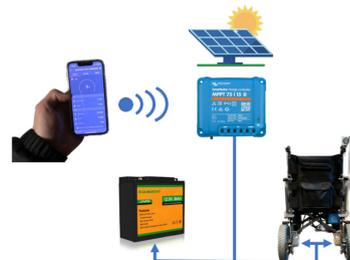
**Abb. 1 Konzept zur Ladekreisenerweiterung mittels Solarpanel und MPPT-Regler**
