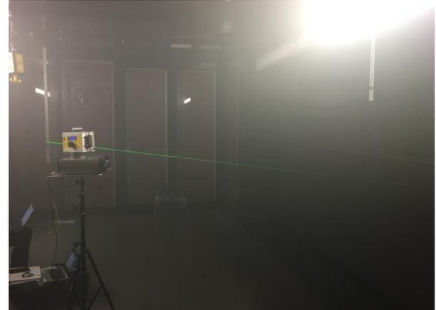
Abb. 5: Raumströmungslabor – Ort der Messungen nach dem Tracergas-abklingverfahren und dem neuen optischen Verfahren
