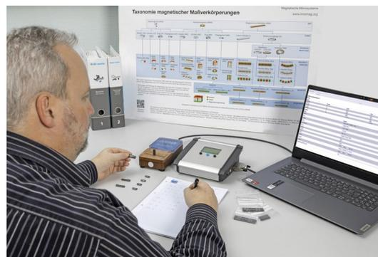
*Abb. 1: ELSOMA C10 Flussdichtemessgerät bei der Wareneingangsprüfung von Motormagneten*
